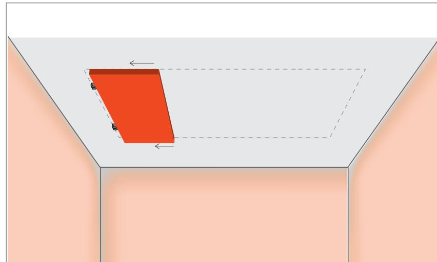
3 Фиксируем панель промежуточными скобами. Затем прикрепляем скобы к потолку.
